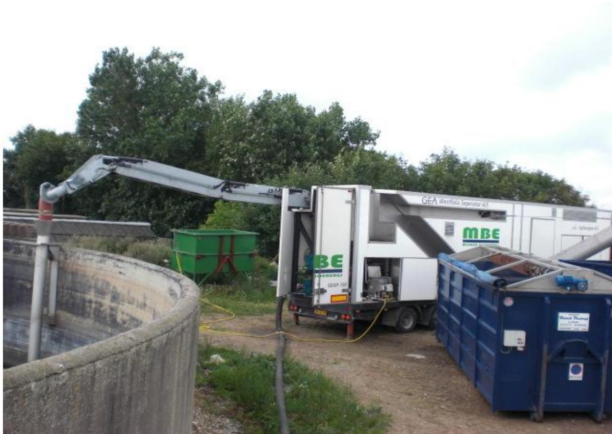
Mobile Dekanieranlage UCD 755 zur Gülle-Aufbereitung in Dänemark.
